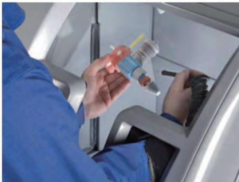
设备配有压缩空气笔，可以在负压条件下将多余的粉末从模型上去除，从而便于将多余粉末进行回收和循环使用。
