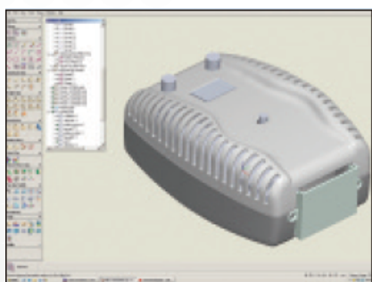
第二概念模型，用于原型制作 并导出至CAD/CAM (Cimatron)。
