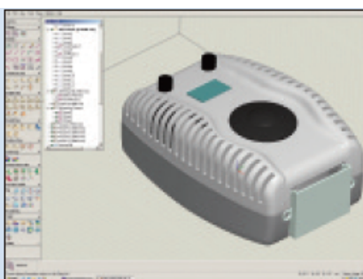
第二概念模型， 用于原型制作并导出至 CAD/CAM (Cimatron)。
